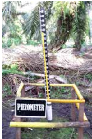
Piezometer, digunakan untuk memantau ketinggian air di lahan gambut.
